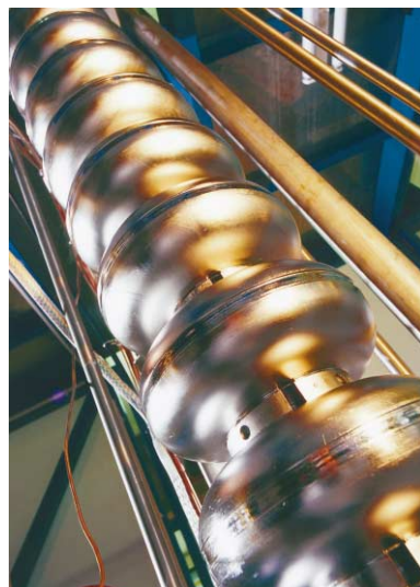
Jeden z nadprzewodzących rezonatorów, w którym TESLA będzie przyspieszać cząstki.
