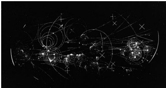
Ślady cząstek subatomowych w komorze pęcherzykowej, ważnym przyrządzie — detektorze fizyki cząstek.
